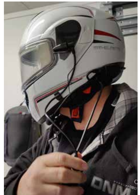
Kypärä on Espanjassa valmistettu. Visiirissä ylhäällä ja alhaalla näkyvät lämpöelementit antavat lämpöä sekä pitävät huurteen poissa huonollakin säällä.
